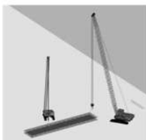
双机抬吊地下连续墙钢筋笼示意图
