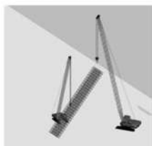
双机抬吊地下连续墙钢筋笼示意图
